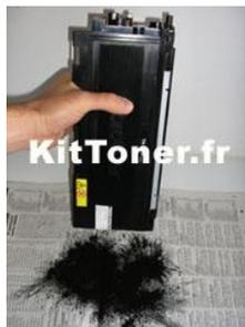
**7** Secouez la bouteille de toner vigoureusement pendant 20 secondes. Enlevez le bouchon ainsi que le scellé et insérez le bec verseur sur la bouteille.
