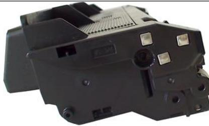
4. Séparez ensuite le support plastique de la cartouche à l'aide si besoin d'un tournevis à tête plate. L'opération permettra de laisser apparaître le bouchon.
