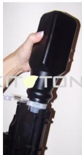
7. Remplacez le bouchon sur la cartouche par le nouveau bouchon fourni dans le kit.
